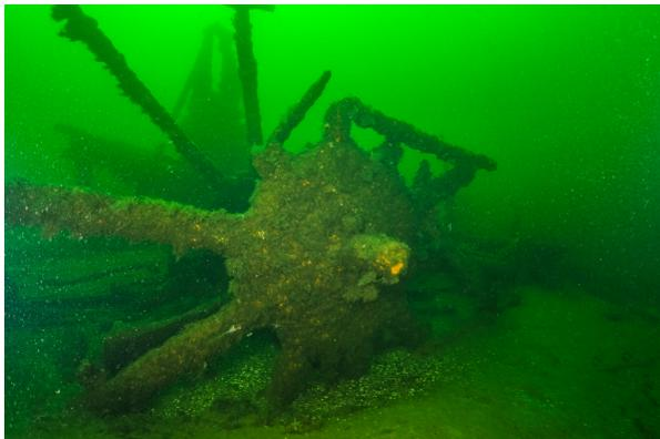
Abb. Seitenrad und Teile der Seitenbalken-Dampfmaschine
